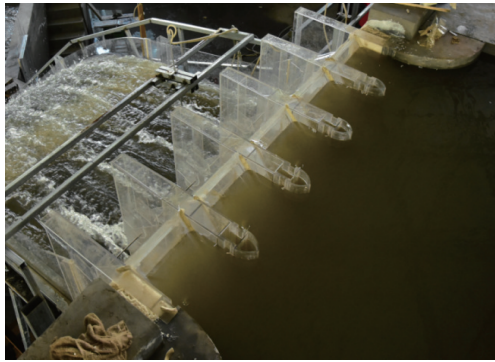
(a) Z5 工况闸室段物模流态
