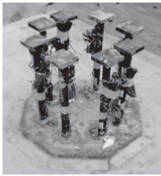
图 11 T 形头钢筋 Fig. 11 T-headed bar
